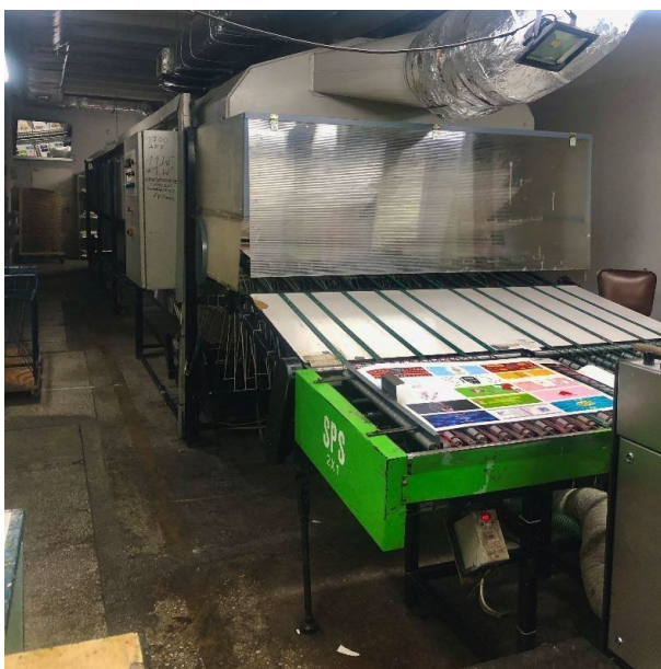
Ryc. 1. Tunel suszący (fot. S. Jaguszewski)
