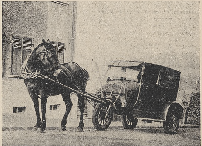
Tak wygląda samochód „jednokonny”: oto auto, które po usunięciu silnika i zamianie na trójkołowiec, przekształcone zostało na wóz, którym piekarz rozwozi pieczywo w Zagłębiu Saary.
